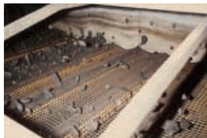
●稼働中のウェーブスクリーン
